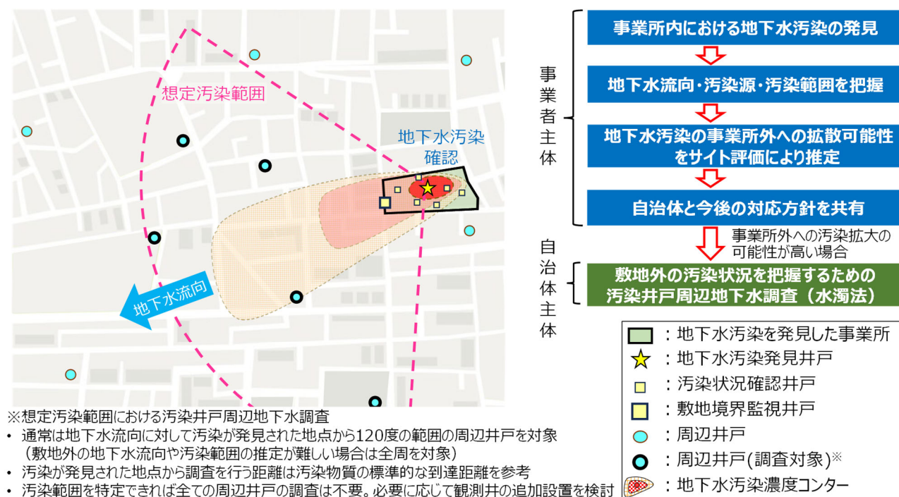
図-3 事業所内汚染発見契機型の概念図と実施手順
