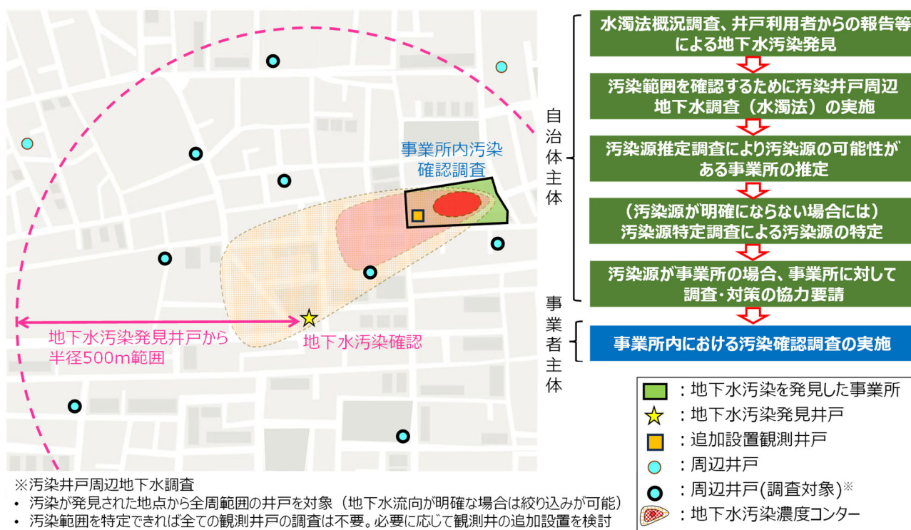
図-4 事業所外汚染発見契機型の概念図と実施手順
