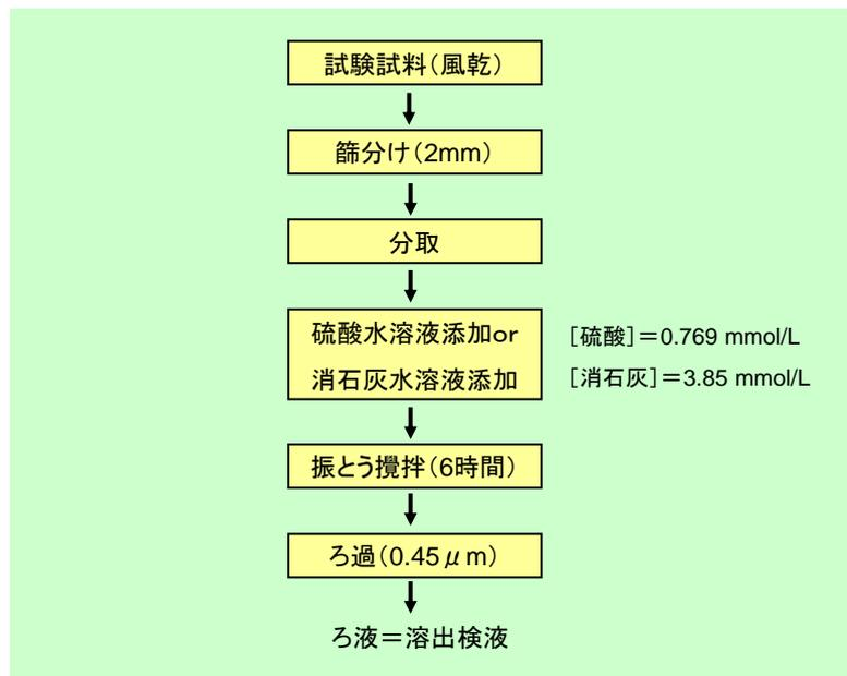
図一2 硫酸添加溶出試験法と消石灰添加溶出試験法の手順
