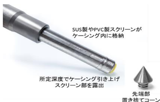
図-3 打撃貫入方式による深度別地下水調査ツール 13) （一部加筆）
